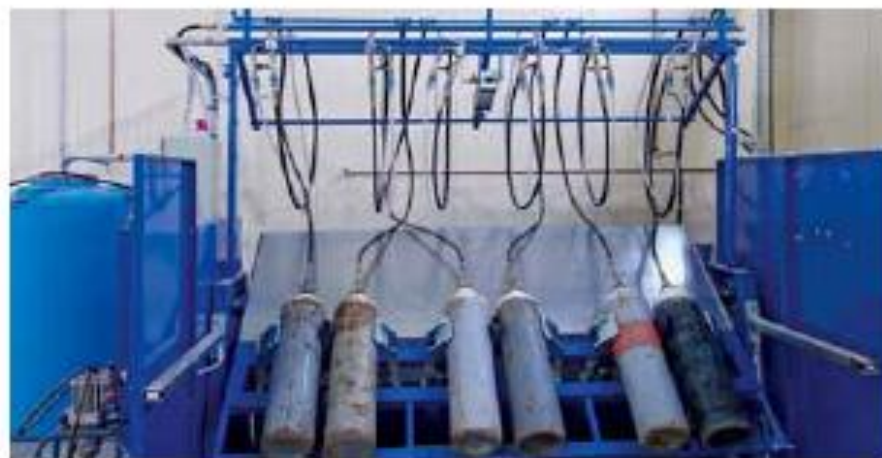
Μηχάνημα υδραυλικής δοκιμής 6 θέσεων, μέγιστη πίεση δοκιμής 450 bar, για φιάλες αερίων και πυροσβεστήρων. Μέγιστη παρογωγική δυνατότητα 30 φιάλες ανά ώρα.
